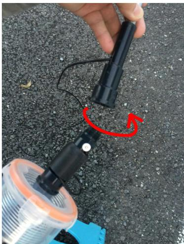
釣竿上部の根元とコイル部の上部を持って、上下の釣竿を分割します。強く締めすぎたときは、焦らずに滑り止めシートなどを巻いて丁寧に外してください。このとき、コイルの下のロッド部を持って回さないでください。**コイルがねじれたりして、破損する恐れ**があります。
