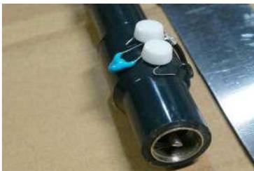
給電部の根元には、マッチング用のコンデンサを挿入するための端子が出ています。下の端子がアース側、上の端子がエレメント側です。高耐圧セラミックコンデンサを使用してください。コンデンサ以外は何も付けないでください。ショートさせてはいけません。アンテナではなくただの釣竿になってしまいます(>\_<)
