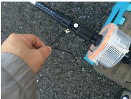
コイル部上部のネジを緩めて、コードを外します。ネジはなくさないように軽く締めておきましょう。
