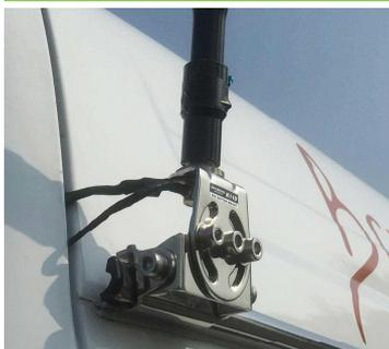
大手メーカーの、大型アンテナに対応している基台に取り付けてください。メーカー製の2メートル長のHFモービルアンテナを付けて、時速100kmで走行できるぐらいの基台が必要です。VUアンテナ用の小型モービル基台では、ちょっとした風でも倒れたり、破損する恐れがあります。
